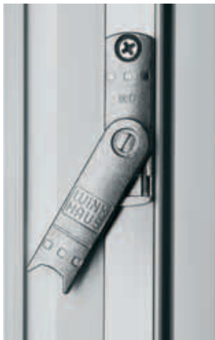
Dvofunkcijski vložek: Varovalo pred nepravilnim odpiranjem preprečuje napačno uporabo okna in s tem preprečuje škodo na okovju in oknu. Integrirani nased dodatno skrbi za natančno zapiranje krila v okvir.
